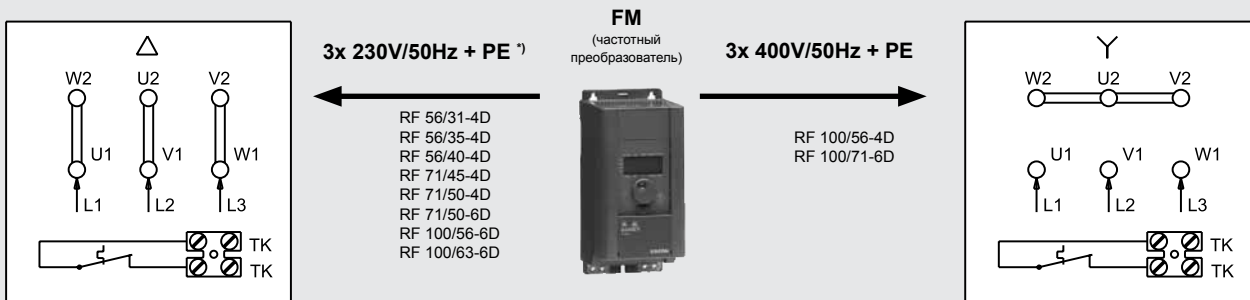
Рисунок 4 – включение Y/Δ на клеммнике трехфазного двигателя
