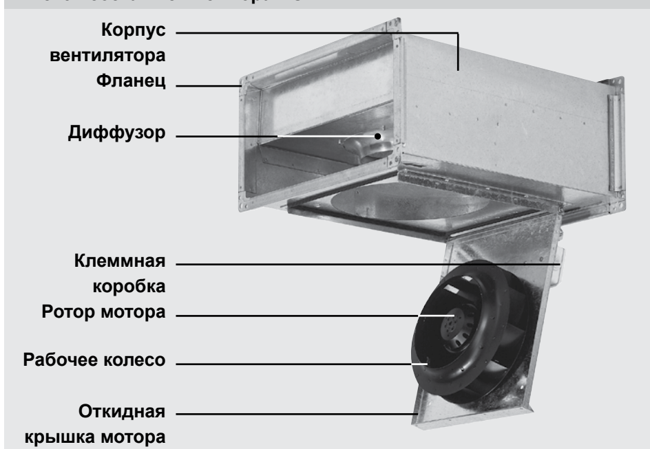
Рис. 3 - состав вентилятора RO
